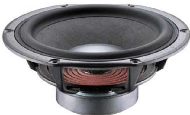
Woofer da otto pollici con cono in Nomex ed anello di corto circuito magnetico in alluminio (Aluring). Molto valido come woofer in sistemi multi-vie con buona estensione alle basse frequenze o per realizzare diffusori a due vie molto dinamici.
