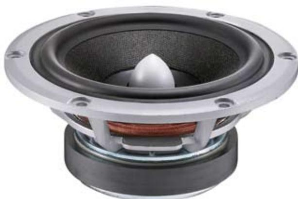
Mid-woofer da cinque pollici con cono in Nomex, anello di corto circuito magnetico in alluminio (Aluring) e polo centrale rivestito in rame (Copper-cup). Per costruire sistemi senza compromessi: é un altoparlante di altissimo livello.
