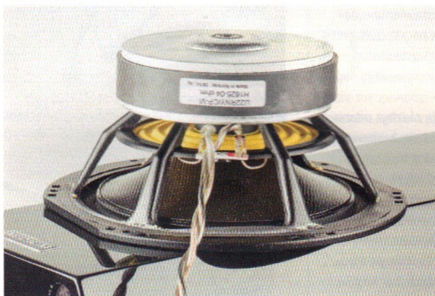
Przetwornik szerokopasmowy ma spory układ magnetyczny, cewka nie ma dodatkowej wentylacji pod dolnym resorem. Głośnik niskotonowy to konstrukcja Seasa.
