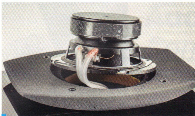
Przetwornik szerokopasmowy ma spory układ magnetyczny, cewka nie ma dodatkowej wentylacji pod dolnym resorem. Głośnik niskotonowy to konstrukcja Seasa.
