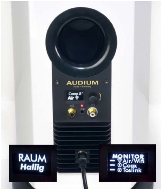
Die Masterbox besitzt zwei Digitaleingänge: optisch und Cinch. Über Display und Wahlschalter lassen sich u.a. Raumcharakter und Eingangspriorität umstellen.
