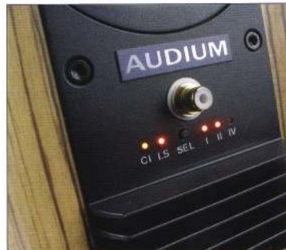
Programmiert wird über den Taster. LEDs zeigen die verschiedenen Betriebsmodi an
