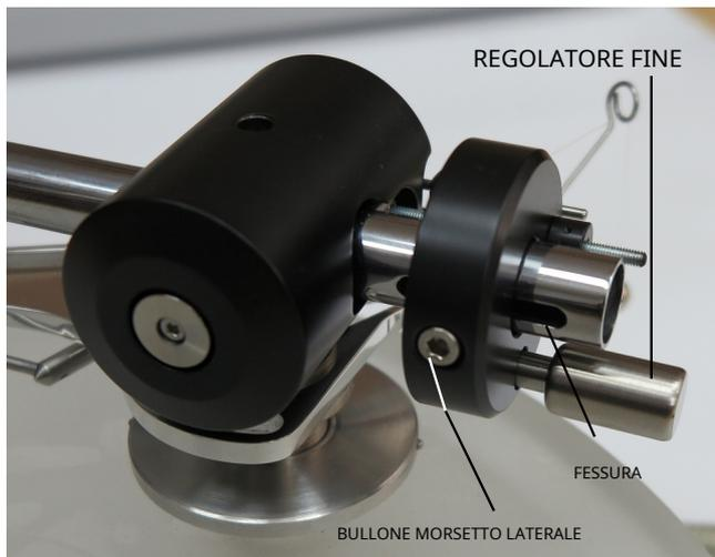
La forza di tracciamento viene regolata facendo scorrere il contrappeso lungo il troncone posteriore e quindi fissandolo saldamente in posizione utilizzando il bullone di fissaggio laterale. La regolazione fine può quindi essere eseguita ruotando il "regolatore fine".
