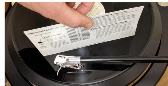
La foto sopra mostra errato orientamento della scheda di allineamento
