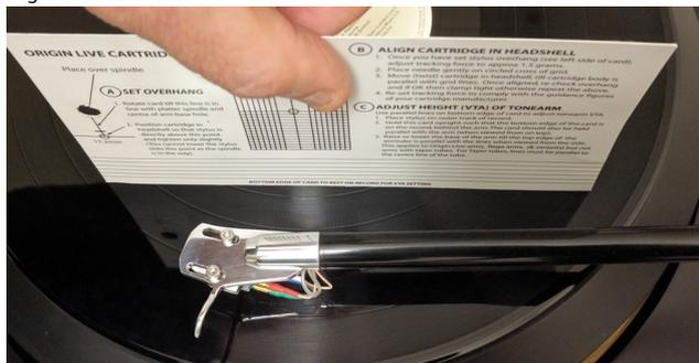
La foto sopra mostra il corretto orientamento della scheda di allineamento
