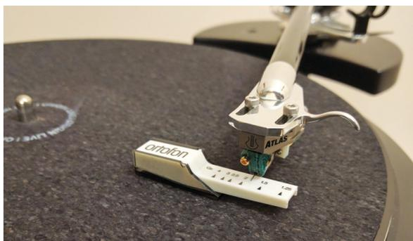
Foto del misuratore di forza dello stilo per impostare la forza di tracciamento
