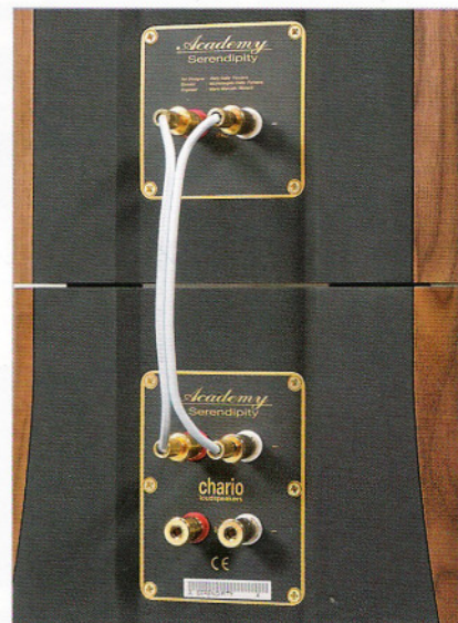
Zwischen Bassabteilung und Lautsprecher steckt ein Verbindungskabel – Trennfrequenz 240 Hertz
